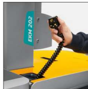
Caricabatterie incorporato con cavo spiralato integrato
