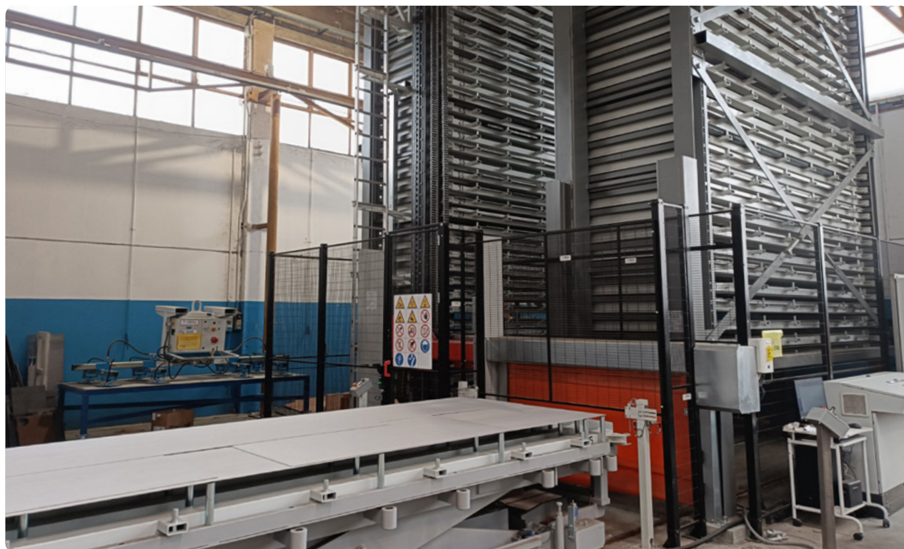
Magazzini verticali per barre e lastre Steel Tower
