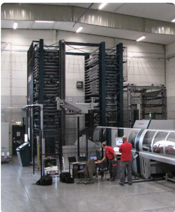
Magazzino automatico per stoccaggio pacchi di lamiera su vassoio (settore meccanico)
