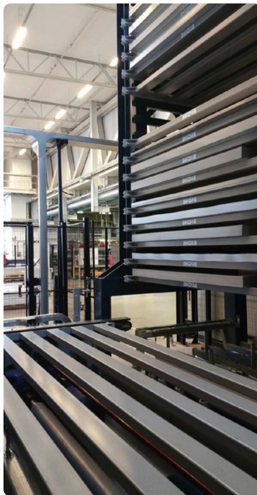
Particolare UDC - Per pacchi di lamiera
