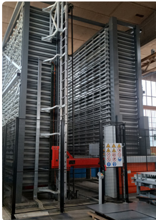
Magazzino automatico per stoccaggio lamiera su vassoio
