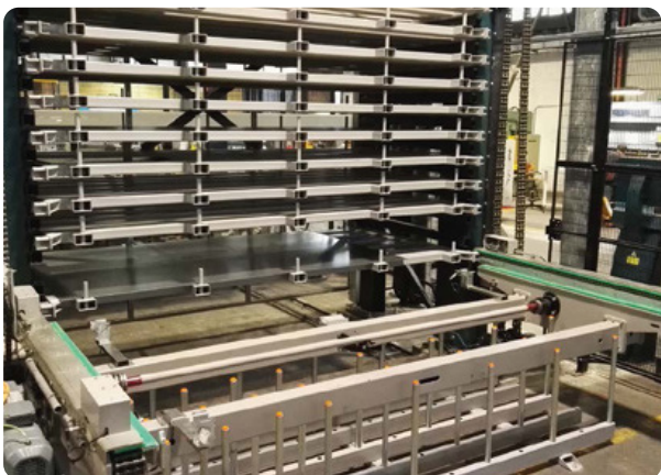
Magazzino automatico verticale per lamiera Steel Tower (settore siderurgico)
